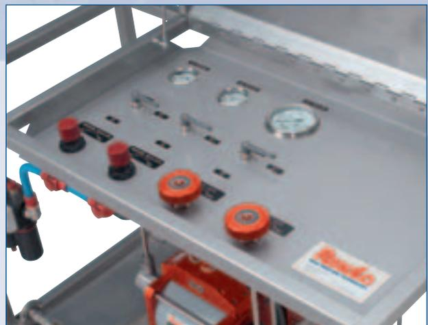
Der Ausgangsdruck wird durch ein Manometer oder optional durch einen Kreisblattschreiber angezeigt. Ein Ablasventil dient zur Druckentlastung.
