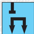
Druckloser Umlauf von Pumpe zu Tank
