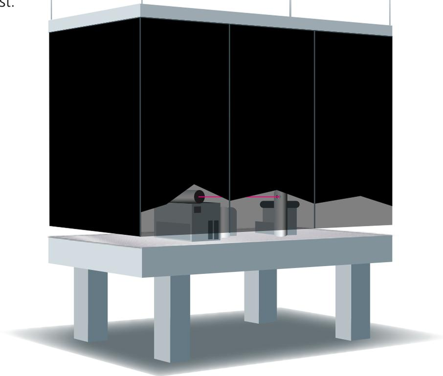
Einfache fahrbare Laserschutzwand in einem Metallrahmen – bespannt mit Laserschutzbereich, festem Metallblech oder Laserschutzglas.
