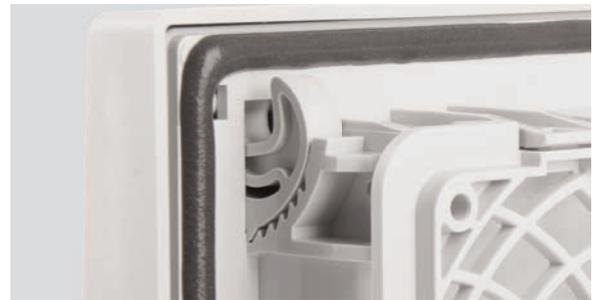
Der Filterlüfter Plus wird von außen in den Schrankausschnitt eingesetzt und werkzeuglos montiert. Durch Betätigen der 6-stufigen Drehriegel wird der Filterlüfter von innen an die Schrankwand herangezogen. Die Drehriegel rasten hörbar ein und geben dem Monteur Rückmeldung, dass das Gerät dicht und stabil sitzt. Die Drehriegelbefestigung ist für Wandstärken von 1 bis 4 mm geeignet.
