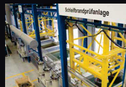
• Automatisierte Anlage zur Schleifbrandprüfung, Marke Fikara.
