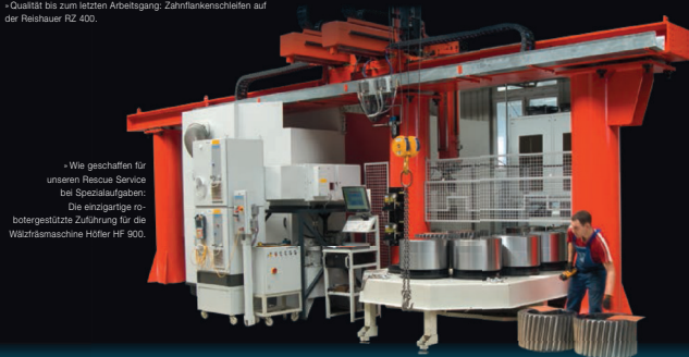
• Qualität bis zum letzten Arbeitsgang: Zahnflankenschleifen auf der Reishauer RZ 400.
