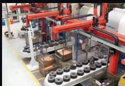
• Effizient und exakt: Vollautomatische Taktstraße mit Bauteilezuführung durch Industrieroboter.
