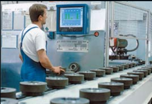
» Qualität bis zum letzten Arbeitsgang: Zahnflankenschleifen auf der Reishauer RZ 400.
