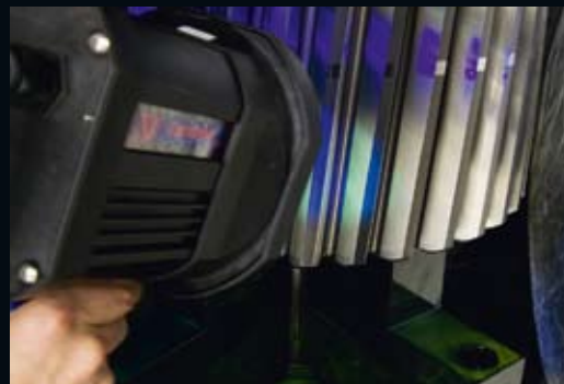
» Magnetpulver-Rissprüfung bis 1800 mm Durchmesser der Firma Karl Deutsch.
