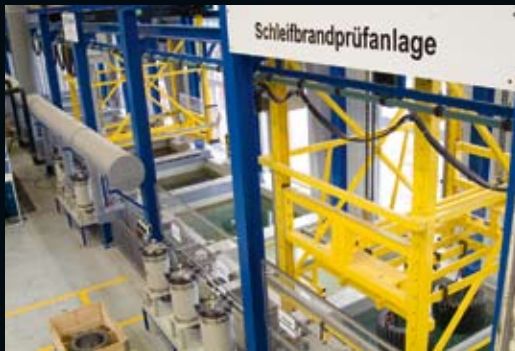
» Automatisierte Anlage zur Schleifbrandprüfung, Marke Fikara.
