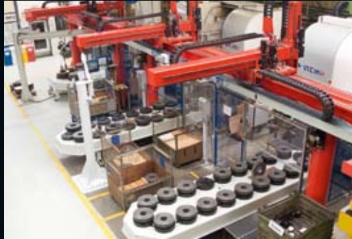
» Effizient und exakt: Vollautomatische Taktstraße mit Bauteilezuführung durch Industrieroboter.
