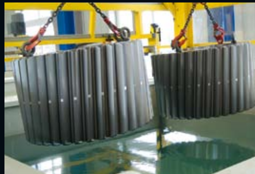
» Schleifbrandprüfung mittels Nitalätzung, bis Durchmesser 1600 mm.
