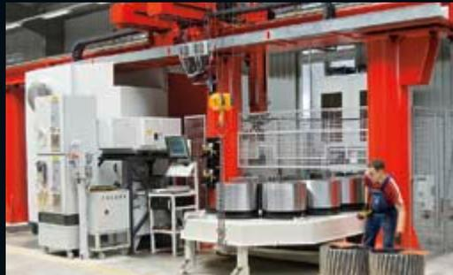
» Verzahnungsmaschine Höfler HF 900 (Wälzfräsmaschine) mit weltweit einzigartiger robotergestützter Zuführung.
