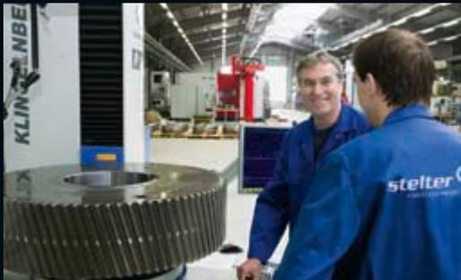
» Profil und Flanken der Zahnräder werden regelmäßig auf Mehrkoordinaten-Messgeräten überprüft.
