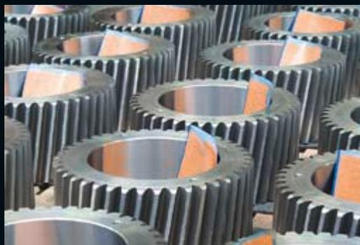
» Planetenräder für Windkraftgetriebe – höchste Qualität, lückenlos dokumentiert.
