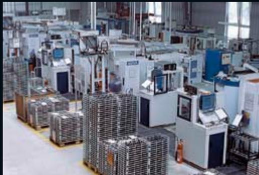
» Bei der Fertigung von Antriebsrädern für Nockenwellenversteller werden nur noch die Ladungsträger den Maschinen zugeführt. Alle folgenden Arbeitsschritte sind automatisiert.
