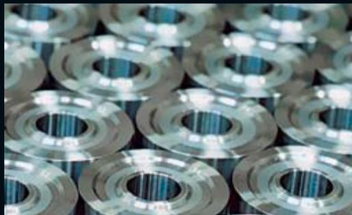
» Drehrohlinge für die Serienproduktionen warten auf den nächsten Arbeitsgang: Die Verzahnung durch die Höfler HF 900, einer CNC-Wälzfräsmaschine der neuesten Generation.
