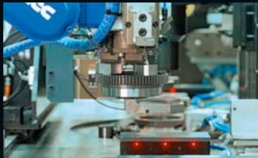
**»Die Montageanlagen für Nockenwellenversteller Einlass/Auslass – made by Stelter – montieren jährlich über 1 Million, zu 100 % geprüfte, Antriebsräder, automatisiert zu Systemeinheiten.**
