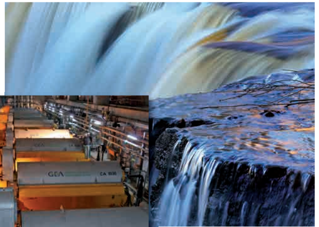
Dekanter für Schlammwässerung
