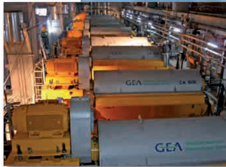
Dekanter für Schlammwässerung
