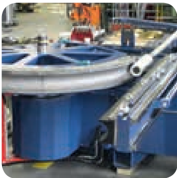
Radien bis 1.500 mm mit präzise bearbeitetem Segmentwerkzeug
