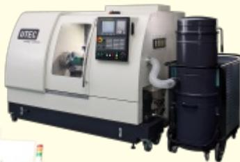
UT1500 – die GROSSE Lösung für Dichtungen zwischen 600 und 1500mm (23,6 bis 59")
