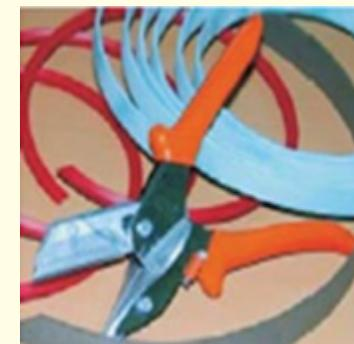
Gehrungsscheren zum Schneiden von Führungsbändern
