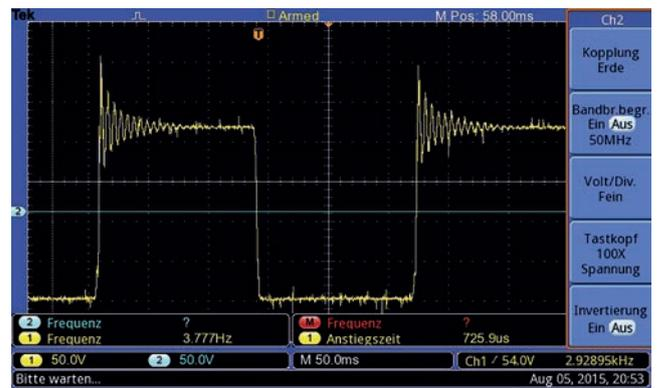
Prüfling am Anschluss A angeschlossen. Druckanstieg ist ungedämpft und zeigt die starke Druckspitze mit Einschwingverhalten und daraus resultierend eine kürzere Druckhaltezeit. Druckabfall ist ungedämpft und fällt steil nach unten auf annähernd 0 bar.
