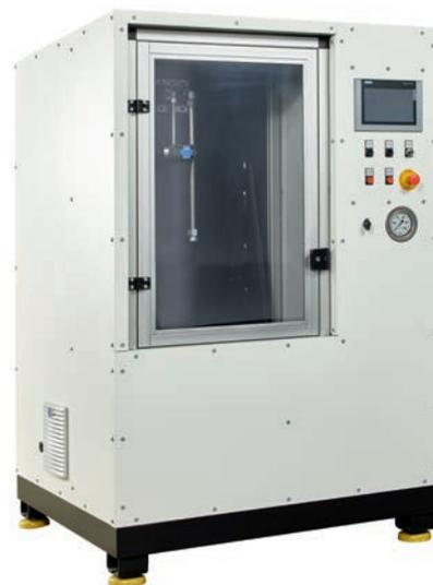
Anwendungsbeispiel eines Pulsationsprüfstandes. In diesem Prüfstand können unter realen Bedingungen die Lebensdauer und Dauerfestigkeit von Komponenten und Bauteilen geprüft werden.
