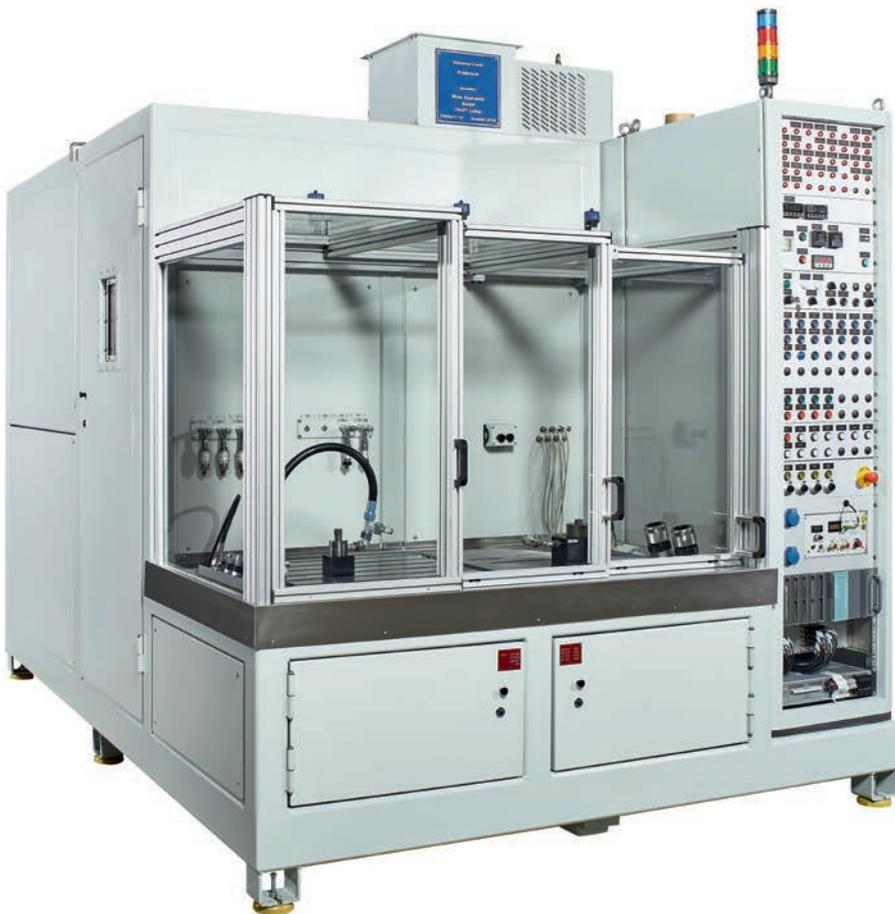
Auf diesem Prüfstand werden universelle Hydraulik- und Ventilprüfungen im offenen und geschlossenen Kreis durchgeführt. Max. Volumenstrom 150 l/min. und ein max. Druck von 560 bar.
