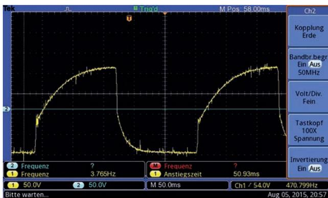
Prüfling am Anschluss A angeschlossen. Druckanstieg ist extrem gedämpft und verzögert die Anstiegsgeschwindigkeit so stark, dass keine Druckhaltezeit entsteht. Druckabfall ist gedämpft und fällt ab ca. 50% verzögert auf annähernd 0 bar.
