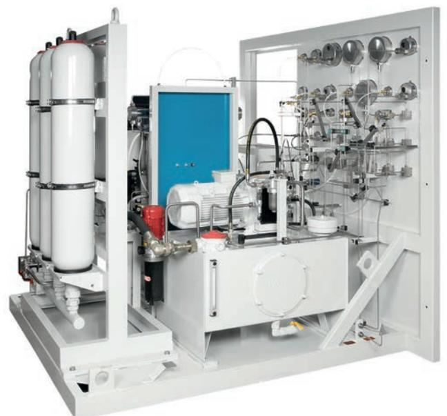
Anwendungsbeispiel eines kundenspezifischen Hochdruckventilprüfstandes. Auf diesem Prüfstand werden Hochdruckventile bis zu 5.400 bar getestet.
