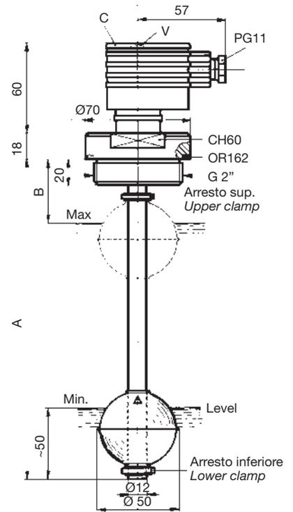
Le sonde di livello SL1FIA...CVS1, SL2FIA...CVS1 e SL1TIA...CVS1, SL2TIA...CVS1 con convertitore di segnale 4/20 mA alloggiato nel connettore C, sono state concepite per controllare in continuo il livello di un liquido contenuto in un serbatoio di stoccaggio.
