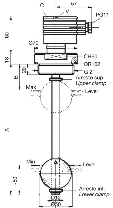
Le sonde di livello SL1F3IA... SL2F3IA..., e SL1T3IA..., SL2T3IA... sono state concepite per controllare il livello di un liquido contenuto in un serbatoio e inviare a distanza tre segnali di allarme regolabili a piacere. Installate sopra un serbatoio contenente il fluido da controllare, trasmettono per mezzo del trasduttore lineare posto all'interno del tubo lungo il quale scorre il galleggiante con magneti, un segnale variabile, in funzione della posizione assunta dal livello del liquido.
