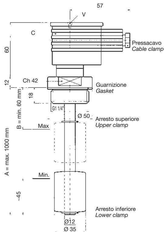
Le sonde di livello SLM1FA...CVS1, SLM2FA...CVS1 e SLM1TA...CVS1, SLM2TA...CVS1 con convertitore di segnale 4/20 mA alloggiato nel connettore C, sono state concepite per controllare in continuo il livello di un liquido contenuto in un serbatoio di stoccaggio.
