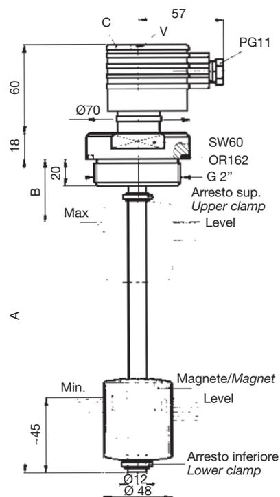
Le sonde di livello SL1FA...CVS1, SL2FA...CVS1 e SL1TA...CVS1 SL2TA...CVS1 con convertitore di segnale 4/20 mA alloggiato nel connettore C, sono state concepite per controllare in continuo il livello di un liquido contenuto in un serbatoio di stoccaggio.
