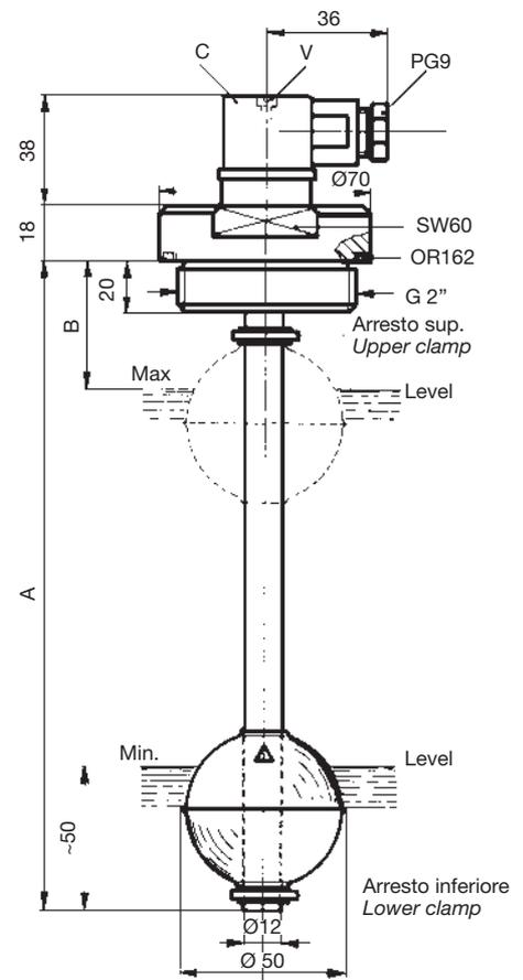
Le sonde di livello SL1FIA..., SL2FIA... e SL1TIA..., SL2TIA... sono state concepite per controllare a distanza in continuo il livello di un liquido contenuto in un serbatoio di stoccaggio, mediante i nostri indicatori digitali.
