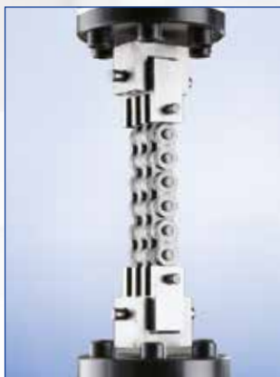
Prüfstand für Dauerfestigkeit
