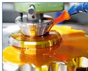
Nuten von Kettenrädern
