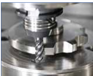
Kettenrad-Fertigung auf CNC-Maschinen
