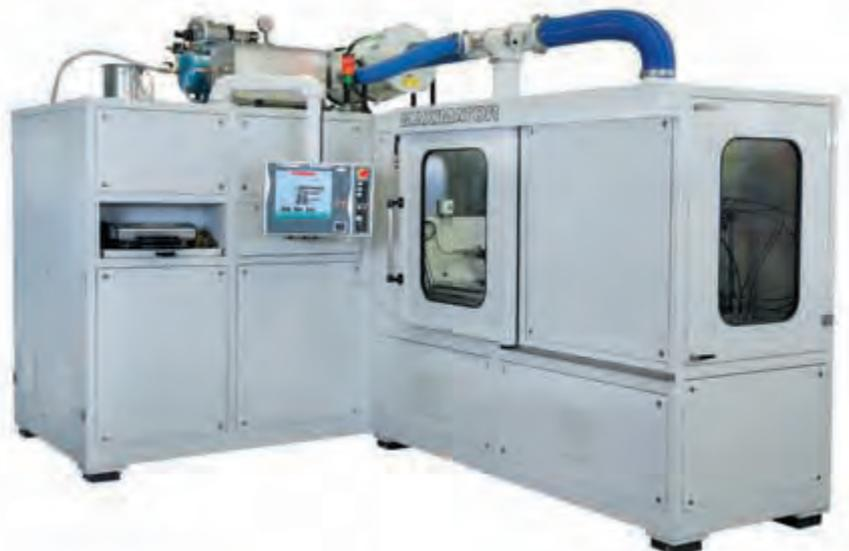
Autofrettage Maschine für Prototypen
