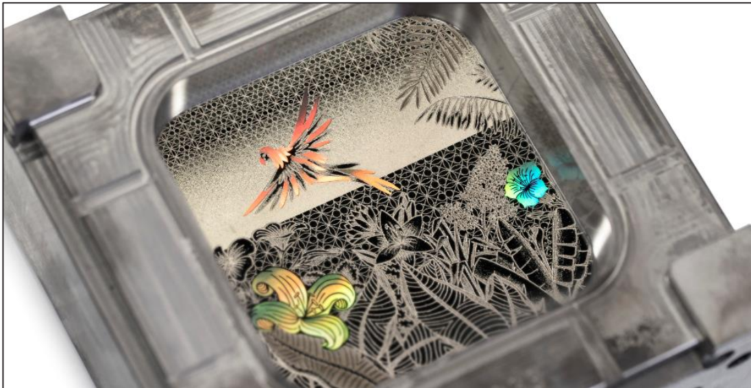
Femtosekunden-Lasermikrofräsen auf gehärteter Stahlform
