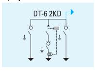
Einen deutlichen, logisches und verständliches Schaltbild ist auf der vordere Seite der DT-6 Anlage vorhanden. Dieses Schaltbild integriert einen Spannungsanzeiger der Typ HR-3, der die Spannungsanwesenheit auf den Kabeln verdeutlicht und den Phasenvergleich zwischen den Einheiten ermöglicht.
