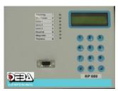
Das digitale UMZ Schutzrelais bietet eine Reihe von Schutzfunktionen und ist mit 4 normalen Ausgangspunkten und 2 programmierbaren Ausgangspunkten versehen. Die Funktionen des Relais sind mit einen Laptop oder direkt über die Tastatur zugänglich
