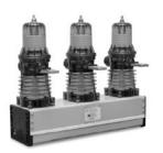
Der von SGC entwickelte Vakuum-Leistungsschalter der Type ISM-086 ist mit Vakuumkammern der letzten Generation ausgestattet. Der Schalter kann nur elektrisch eingeschaltet werden. Wen keine Hilfsspannung vorhanden ist kann der Schalter mit einem Handangetriebene Generator gespeist werden. Der Schalter kann aber manuell oder elektrisch ausgeschaltet werden. Der Schalter wird mittels einen Kontroll-Modulen und einen digitalen UMZ Schutzrelais RP600 mit drei Stromwandlern gesteuert
