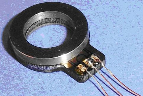
*Sensorsystem bestehend aus einer einseitig polierten und mit dem Dünnschichtsensormaterial ( $d=9\ \mu\text{m}$ ) beschichteten Unterlegscheibe mit Kontaktbereich und einem Gegenring.*
