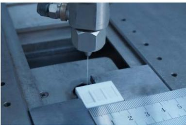
Abb. 2: Materialabtrag an  $\text{Al}_2\text{O}_3$  mittels Wasserabstrahlfeinstrahl
