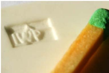
Abb. 1: Strukturiertes IWP-Logo auf Aluminiumoxid ( $\text{Al}_2\text{O}_3$ )
