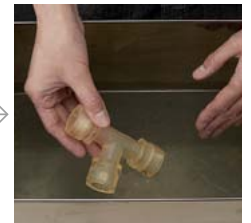
Selbst bei Baugruppen und komplexen Formen lässt sich das Supportmaterial durch ein Wasserbad entfernen.
