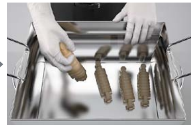
Arbeitskosten lassen sich verringern, wenn das Supportmaterial durch ein Wasserbad aufgelöst wird.
