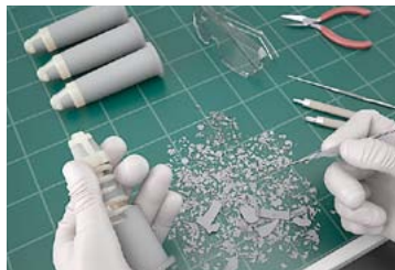
Durch das manuelle und aufwendige Entfernen von Supportmaterial entstehen zusätzliche Arbeitskosten.
