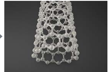
Beispiel für das gleiche Modell, wenn das Supportmaterial durch Einlegen in Wasser entfernt wurde.
