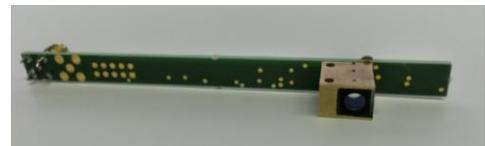
Abb. 3: UV-Beleuchtung mit ns-Pulser-Elektronik
