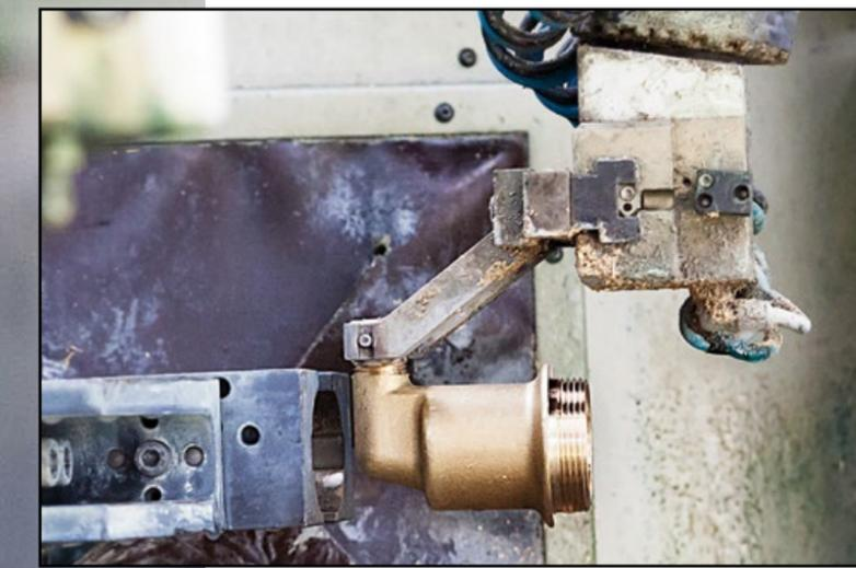
Il reparto di stampaggio è dotato di presse automatiche a gestione elettronica in grado di produrre articoli di diversi pesi e dimensioni per i più svariati settori. L'alta qualità dei prodotti ottenuti è garantita da pirometri ottici che permettono il controllo e la registrazione della temperatura di stampaggio. Di seguito alcune leghe che possono essere fornite: CW617N, CW625N, CW626N, CW724R, CW510L, CW511L.
