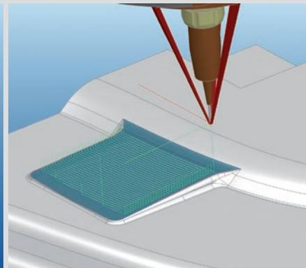
**Parameter Pulverprozess:** Pulvermenge für bis zu 4 Pulverförderer, Schutzgas, Trägergas, Spurhöhe (= Schichtabstand, auch variabel), Laserleistung (auch lagenabhängig variierbar), maximaler Knickwinkel in Kontur, alle Parametersätze können für Konturfahrt und Flächenfüllung separat gewählt werden
