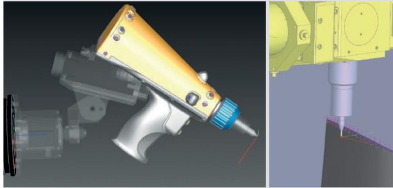
Entlang einer vorgegebenen Kante eines Flächenmodells werden in einer bestimmten Reihenfolge Messpunkte angefahren und als IST-Positionen in der Steuerung abgelegt.
