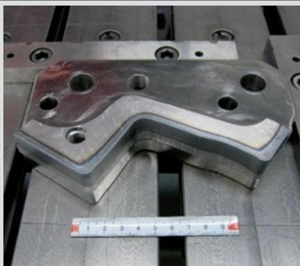
**Spur härten:** Bearbeitung entlang einer Vektorkontur, auch variable Spurbreiten werden unterstützt
