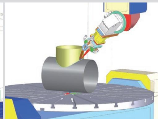
**Laserschweißen:** Mit Bahnoffset, diverse Anfahrvarianten, Angabe von Stechend/Schleppend, seitliche Neigung/Kehlnähte
