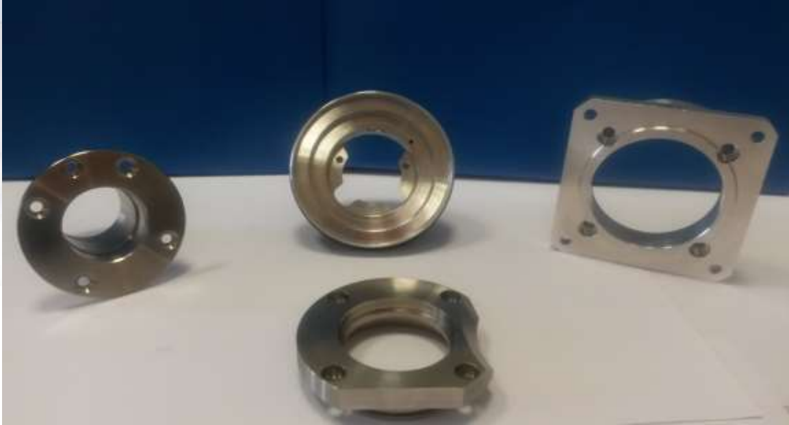
Flansch-Herstellung durch Drehen, Höchstdurchmesser 300mm. Gleichzeitiges Fräsen möglich.
