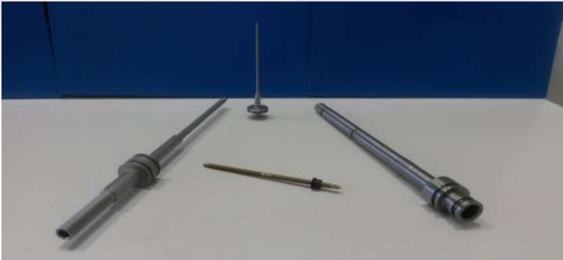
Drehen größerer Längen ist durch Langdrehmaschinen möglich.
