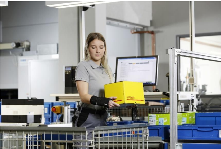
Das neue Paexo Wrist unterstützt das Handgelenk beim Heben und Halten schwerer Gegenstände.
