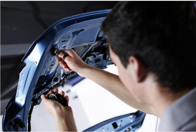
Das kleinste Exoskelett der Welt – Paexo Thumb – leitet die Kräfte vom Daumen in die gesamte Hand ab.
