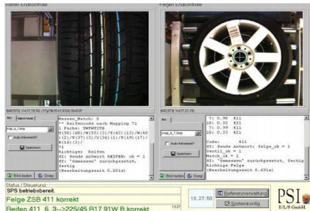
können, nur durch Eingabe von Musterbilddaufnahmen neuer Teststücke. Hierdurch werden die Softwareanpassungskosten bei neuen oder modifizierten Prüfaufgaben drastisch gesenkt. Die Anwender sind in der Lage, die Lösung selbstständig mit Musterbilddaufnahmen zu trainieren und Anpassungen an der Referenzdatenbank vorzunehmen.
