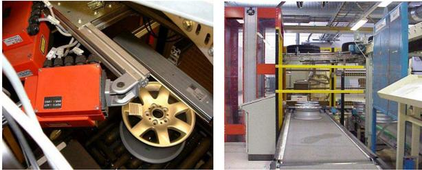
Hier ein Beispiel aus der Automobilzulieferindustrie: In einem hoch automatisierten Prozess werden Reifen und Felgen zu Rädern montiert, die direkt an die Fahrzeugmontagegelinie geliefert werden.
