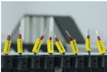
Adern werden automatisch auf die gewünschte Länge zugeschnitten. Bei Bedarf werden die Drahtenden mit Aderendhülsen versehen. Optionale Schilder mit Zielbezeichnungen sorgen für eine fehlerfreie Verdrahtung.
