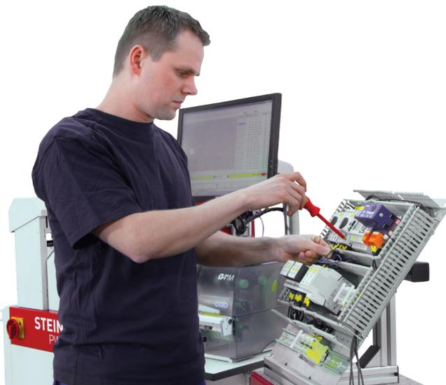
Der PWA 5000 wird zur Verdrahtung von Montageplatten eingesetzt. Während der Verdrahter eine Ader montiert, fertigt der PWA bereits die nächste Ader an.
