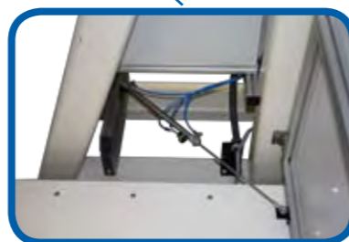
Die vollautomatische Maschinentür öffnet, schließt und verriegelt per Knopfdruck.
