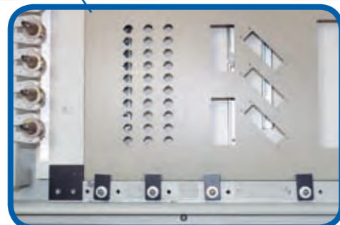
Pneumatische Frontspannung 6 pneumatische Muskeln im unteren Maschinenrahmen fixieren Flachmaterial auf Knopfdruck. Zur Vermeidung von Sperrflächen im Spannbereich sind sie einzeln abschaltbar. Der Lack an den Fixierpunkten bleibt unbeschädigt.
