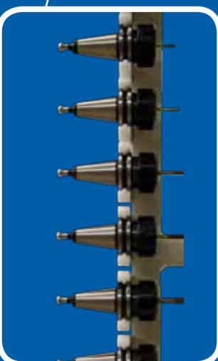
Das Werkzeugmagazin mit bis zu 21 Präzisionswerkzeugen.
