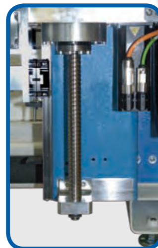
Spanresistente Positioniertechnik mit Kugelrollspindeln und Linearführungen auf allen Achsen.
