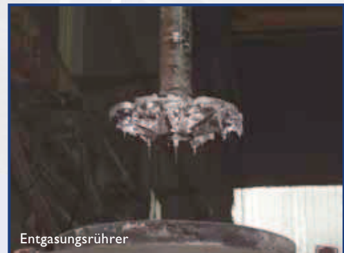
Entgasungsstation für Flüssig-Al-Transportbehälter
