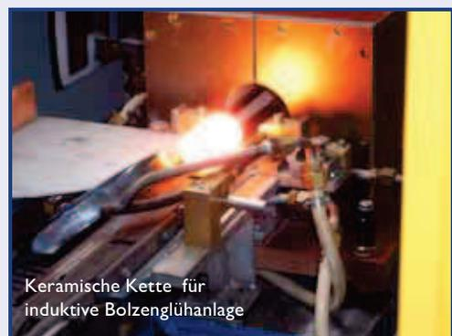
Keramische Kette für induktive Bolzenglühanlage
