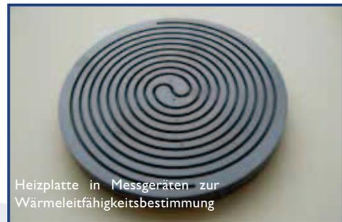
Heizplatte in Messgeräten zur Wärmeleitfähigkeitsbestimmung
