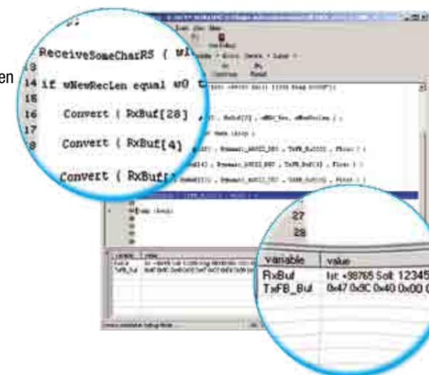
Bild 4: Debugfenster mit Variablen und deren Inhalt
