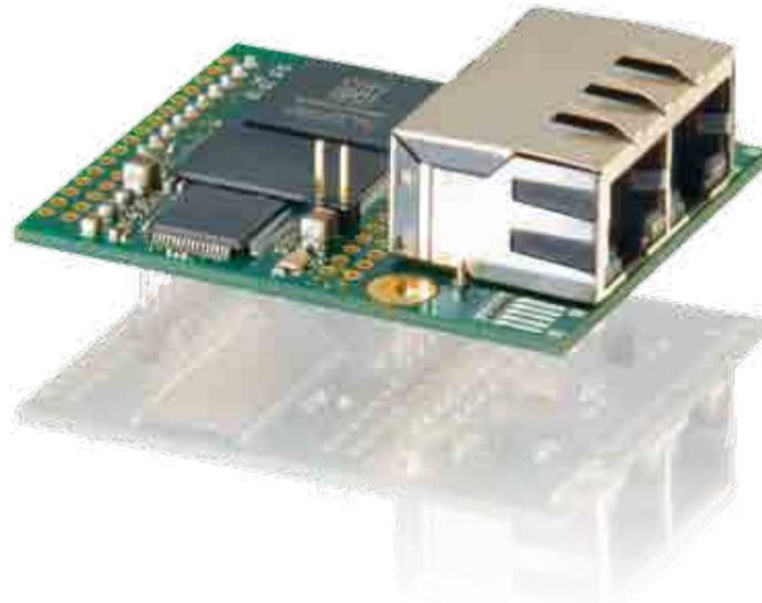
Das Modul wickelt den gesamten Bus-bzw. Ethernet-Datenverkehr ab und entlastet den Endgeräteprozessor somit von diesem nicht unerheblichen Aufwand.
