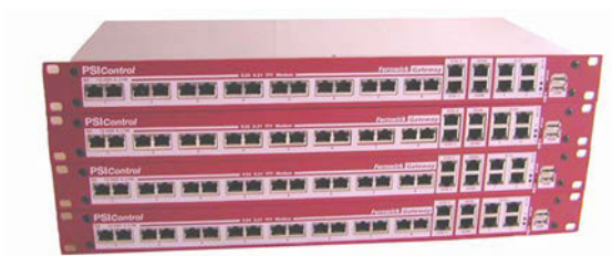
Bild 2: Fernwirkgateway, hier mit 32 Schnittstellen
