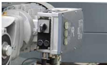
Schalter und Taster sind unmittelbar an den Antrieben angeordnet und erlauben den direkten Start, Stopp sowie Modusänderungen.
