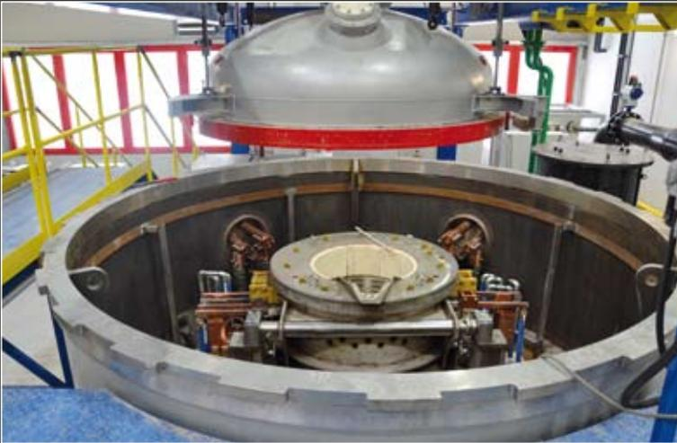
Gießverfahren für Block und Formguss im Vakuumofen bis 50 l (Stahl, Ni-Superlegierungen, Al-Legierungen u. a.)
