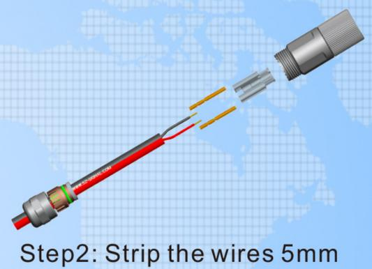
Step2: Strip the wires 5mm
