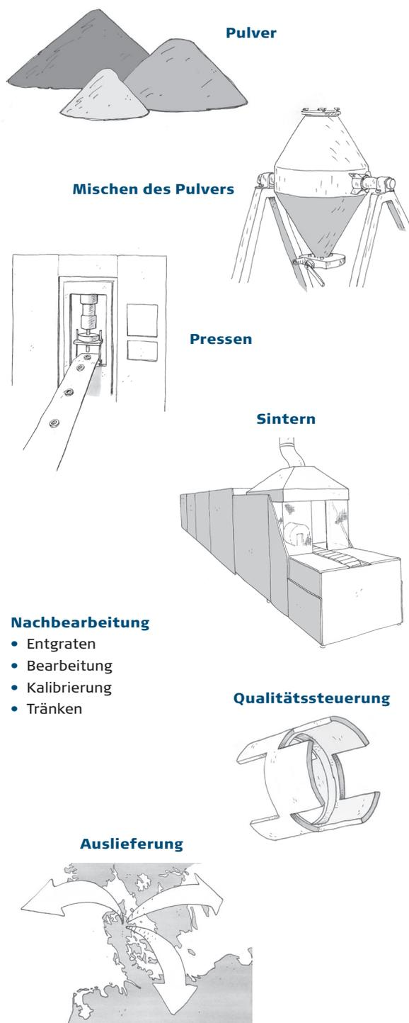
Das Fertigungsverfahren beginnt damit, daß das rostfreie Stahlpulver mit einem Schmiermittel gemischt und in eine vorgegebene Geometrie gepresst wird. Anschließend werden die Bauteile in einer kontrollierten Atmosphäre bei hohen Temperaturen in High-Tech-Sinteröfen gesintert.
