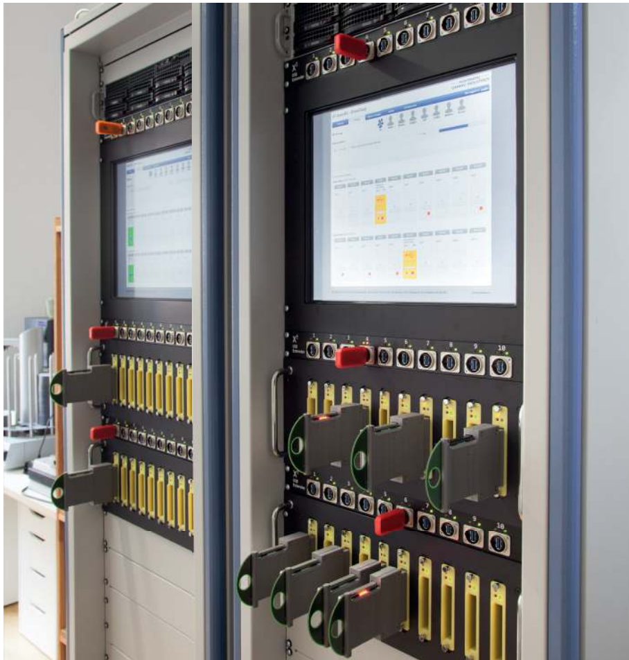
Die Standardversion X 5 Basic ist mit mindestens zwei Modulen, Monitor und Server ausgestattet.
