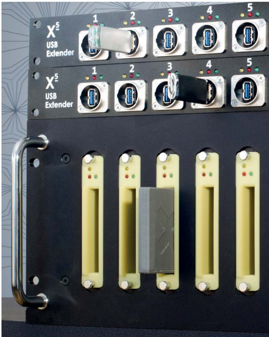
Ein X 5 System kann mit bis zu 8 (unterschiedlichen) Modulen ausgestattet werden.
