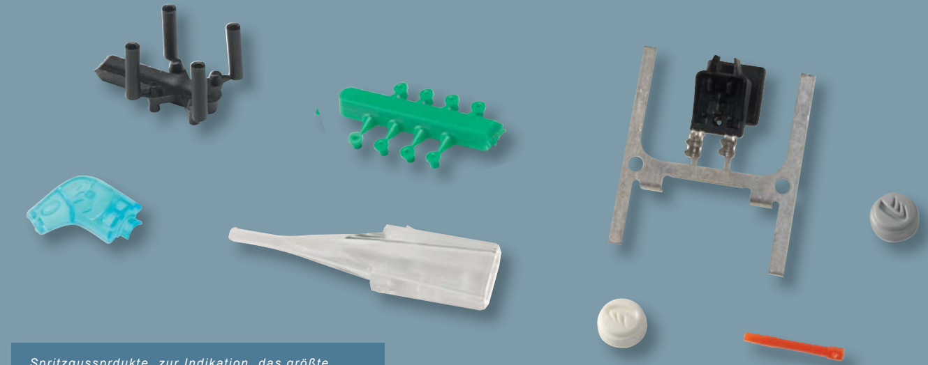
Spritzgussprodukte, zur Indikation, das größte Produkt hat eine Länge von 50 mm
