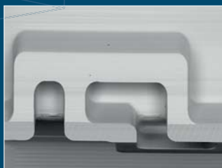
gefrästes Teil vom Werkzeug, 100 µm Fräse
