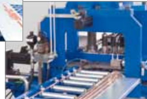
Einlaufbahn mit Rollentisch
