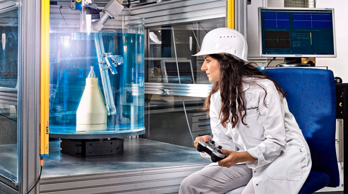
Hochfrequenz-Ultraschall zur Untersuchung einer Raketendüse
