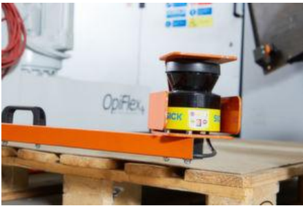
Für Sicherheit sorgen zwei S300 Mini Remote von Sick, die fest auf der mobilen Roboterzelle verbaut sind. (Bild: SICK AG)
