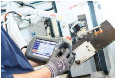
Der Roboter programmiert sich automatisch. Der Bediener muss lediglich einige Fragen beantworten und dem Roboter ein paar einfache Bewegungen einlernen. (Bild: SICK AG)
