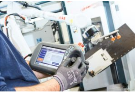
Der Roboter programmiert sich automatisch. Der Bediener muss lediglich einige Fragen beantworten und dem Roboter ein paar einfache Bewegungen einlernen. (Bild: SICK AG)
