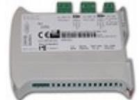
Bei vielen umgerüsteten Fahrzeugen müssen Steuerfunktionen, die vom Motorsteuergerät des ursprünglichen Antriebs bereitgestellt wurden, von der E-Car-Box übernommen werden. Dies geschieht meist über den Fahrzeug eigenen CAN-Bus. Um diesen galvanisch und logisch von der E-Car-Box zu trennen, ist es erforderlich, ein **CAN-Gateway** einzusetzen. Das Gateway wird hierzu von E-Car-Tech fahrzeugspezifisch programmiert.
