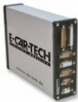
Das „System Electronic Interface“ (kurz SEI) übernimmt als elektronische Schnittstelle die Kommunikation zwischen der E-Car-Box und dem Fahrzeug, und bietet dabei ebenso Sicherheits- wie auch Komfortfunktionen. Es besitzt Schnittstellen zu den wichtigsten Fahrzeugkomponenten und übernimmt die logische Vorverarbeitung und Verknüpfung von Fahrzeugdaten und Signalen.
