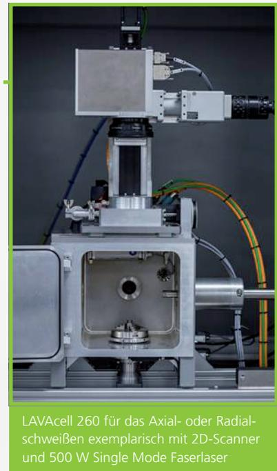
LAVAcElla 260 für das Axial- oder Radialschweißen exemplarisch mit 2D-Scanner und 500 W Single Mode Faserlaser
