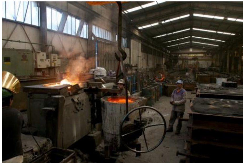
Figura 12 – Fornos de indução INDUCTOTHERM® com 250,500 e 1500 Kg de capacidade.
