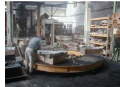
Figura 8 - Carrossel de moldação manual IMF® equipado com misturador contínuo de capacidade 10ton/hora.
