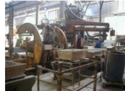
Figura 7 – Linha Automática de moldação tipo “fast-Loop” equipada com misturador contínuo de capacidade 15 ton./hora.
