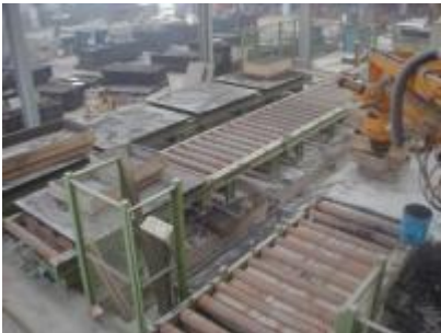
Figura 9 – linha de moldação semi-automática/Manual IMF® Com placas até 2000x1500 mm de dimensões máximas
