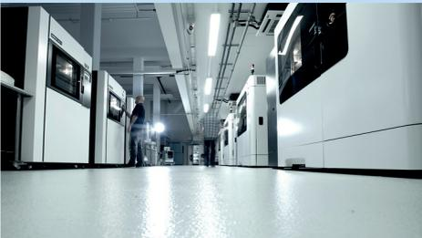
Seit 2006 fertigt die TEILEFABRIK 3D-Bauteile aus den unterschiedlichsten thermoplastischen und polymeren Kunststoffen für Unternehmen in Dienstleistung. Zum Einsatz kommen modernste FDM- und PolyJet-3D-Drucker von Stratasys sowie HP MJF-Anlagen.
