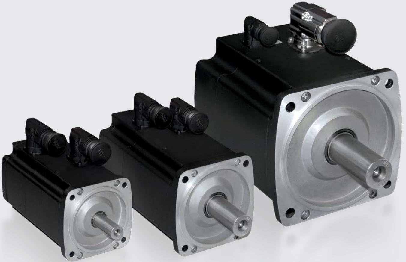
Für Anwendungen mit hohen Drehzahlanforderungen ergänzen die Servomotoren „Pace“ die bestehende DSC-Baureihe um Nenndrehzahlen bis 6000 U/min. Das Outfit ist identisch mit dem der kompakten DSC-Synchronmotoren und der Baureihe dynamischer Servomotoren DSD. Die DSP-Motoren eignen sich durch ihre guten Beschleunigungs- und Überlastfähigkeiten sowie dem gesteigerten Drehzahl- und Leistungsbereich besonders gut für Anwendungen in:
