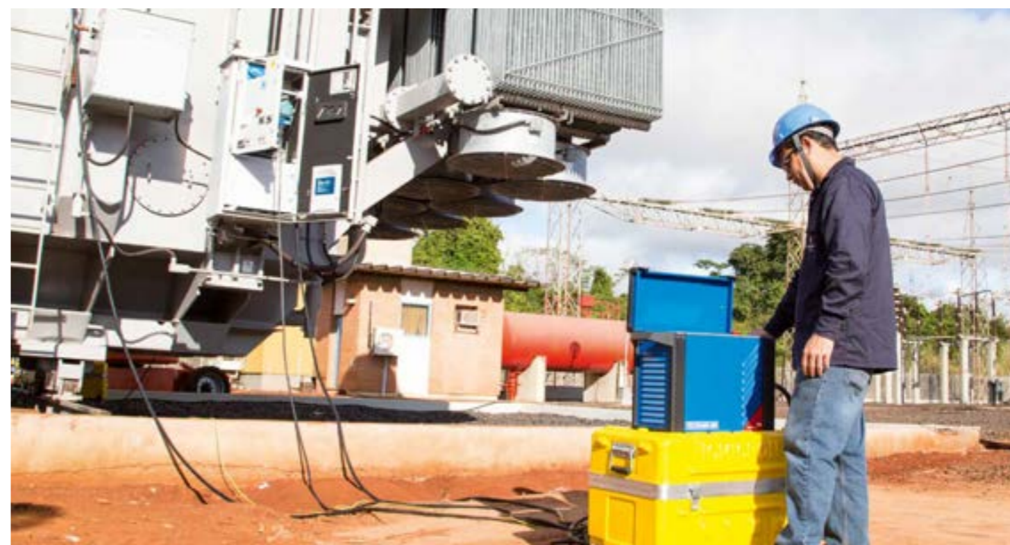
MPD 500 System zur routinemäßigen Teilentladungsmessung und -analyse
