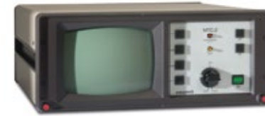
Ein Meilenstein in 1987: Das erste DOS-PC-gesteuerte Stoßspannungsprüfgerät MTC2 mit 6000 V.
