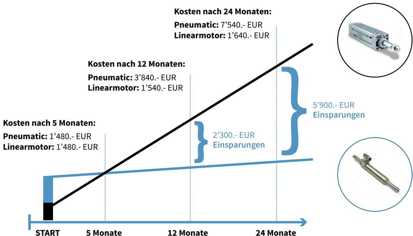
Ein Linearantrieb kostet inklusive aller für den Betrieb notwendiger Komponenten (Kabel, Umrichter etc.) zwar mehr als ein Pneumatikantrieb (inkl. Ventile, Schläuche, etc.). Doch, durch die wesentlich geringeren Energiekosten, amortisiert sich der elektrische Antrieb in weniger als einem halben Jahr. Danach kommt es zu spürbaren Entlastungen! So übersteigen die Energiekosten in dem Beispiel die Investitionskosten für den Pneumatikzylinder bereits nach drei Monaten.
