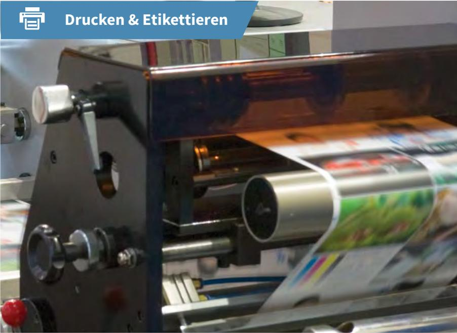
Empfindliche Produkte können mittels Linearmotortechnologie schneller bedruckt werden, da der Druckvorgang positions-, geschwindigkeits- und kraftkontrolliert durchgeführt wird. Es treten keinerlei Kraftstöße auf, wie dies bei pneumatischen Lösungen der Fall ist.
