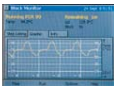
Graphische Anzeige des Temperaturverlaufs während einer 3-Schritt-PCR.
