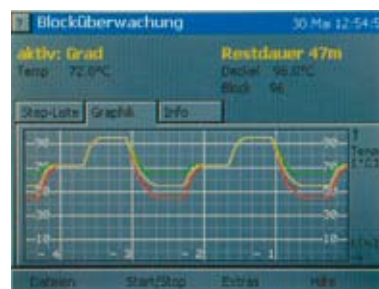
Graphische Anzeige des Temperaturverlaufs einer 3-Schritt-PCR bei einer Temperatur von 55°C in der Blockmitte und einem Gradienten von +/- 10°C. Die minimale Annealing-Temperatur beträgt 45°C, die maximale 65°C.
